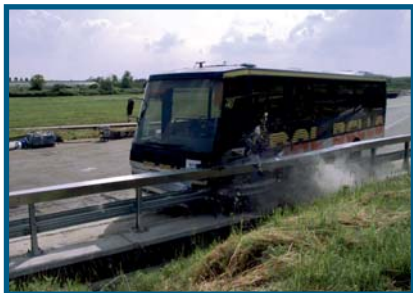
Ensayo TB 51 Bus, 13.000 Kg., a 70 Km/h y 20°.
